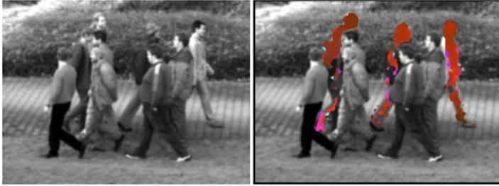
**Abbildung 1.6:** Erkennung von Fußgänger durch Bewegungsanalyse. Die nach rechts laufenden Personen sind im rechten Bild rot markiert. (von Christoph Garbe, IWR, Universität Heidelberg, [273]).
