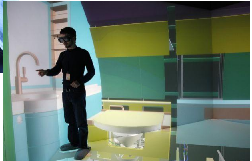
Planung des Einbaus von Kabinenelementen in ein Flugzeug
